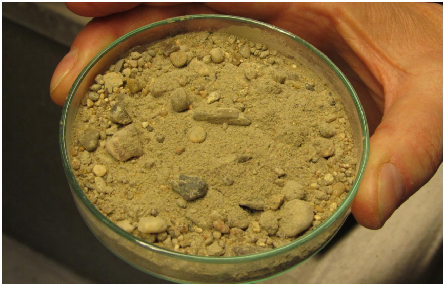
Foto Nr. 1 zeigt das genutzte Material (Gartenbeton mit Trass)
