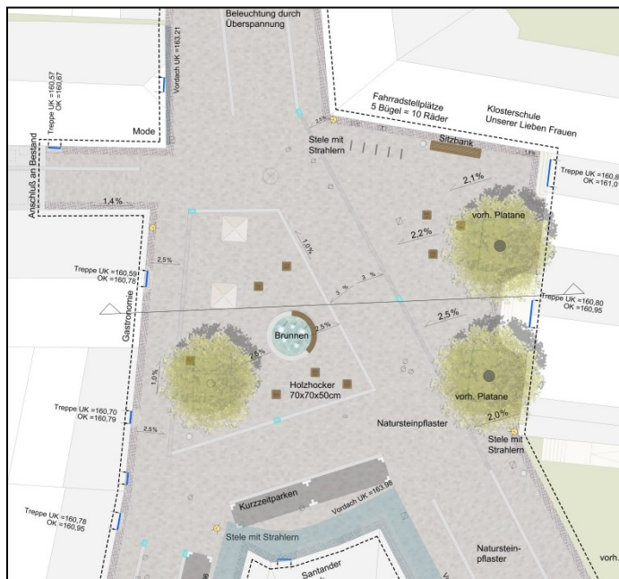
Abb. 6: Klosterplatz – weiterzuführende Variante (Wettbewerbsergebnis, als durchlaufendes Stadtparkett; weiterentwickelt mit Rinnen, diese teilweise ausgestaltet zur Verkehrsführung, teilweise unauffällig in Parkettmuster)
