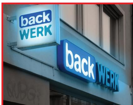
ABB. 119 ❌ **NEGATIVBEISPIEL** Hohe Lichtstreuung und Störung im Farblichtgefüge
