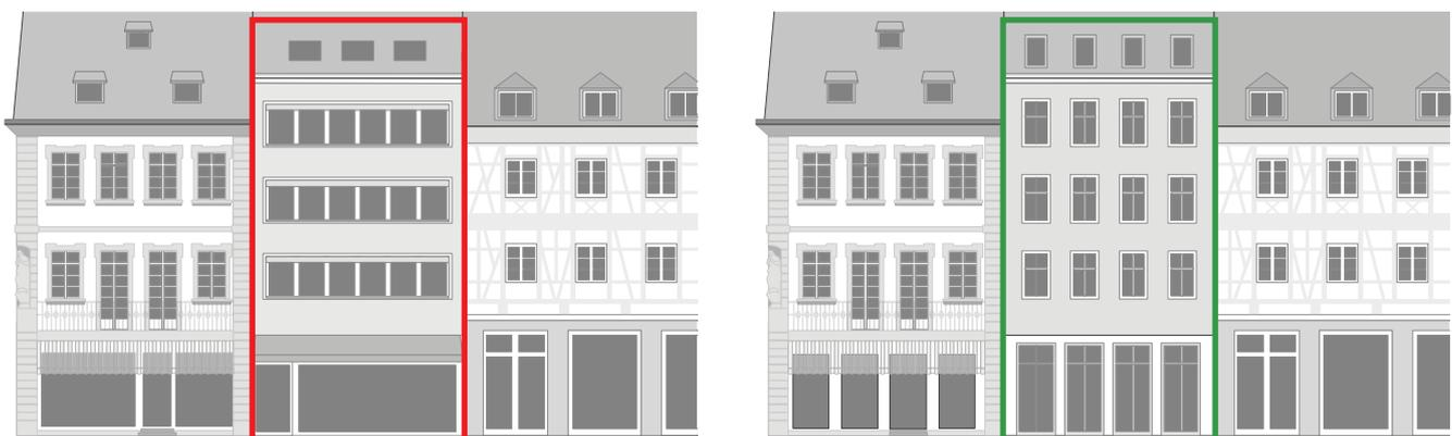
ABB. 012 Gegenüberstellung: Horizontale Fassadengliederung – Behebung der Störung durch Anpassung an die vertikale Fassadengliederung
