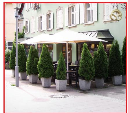
ABB. 160 **⊗** NEGATIVBEISPIEL Barriereartige Situation durch zu enge Stellung
