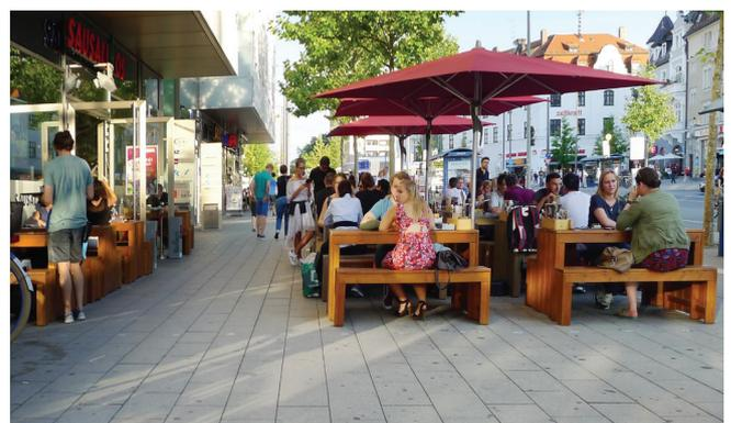
ABB. 145 Ausreichender Korridor für Gehweg (Regelbreite 2,25 m)
