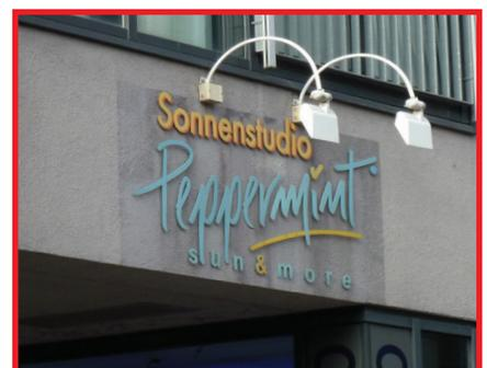
ABB. 120 ❌ **NEGATIVBEISPIEL** Werbeleuchten dominieren die Werbeanlage und die Fassade
