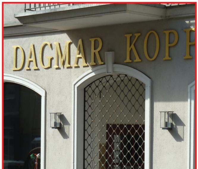
ABB. 106 ❌ **NEGATIVBEISPIEL** Nicht nur die maximale Buchstabenhöhe ist ausschlaggebend, auch das Größenverhältnis und die Abstände zu den Bauteilen
