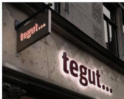
ABB. 116 Geringe Lichtstreuung: Ausleger und Schriftzug mit LED-Technik
