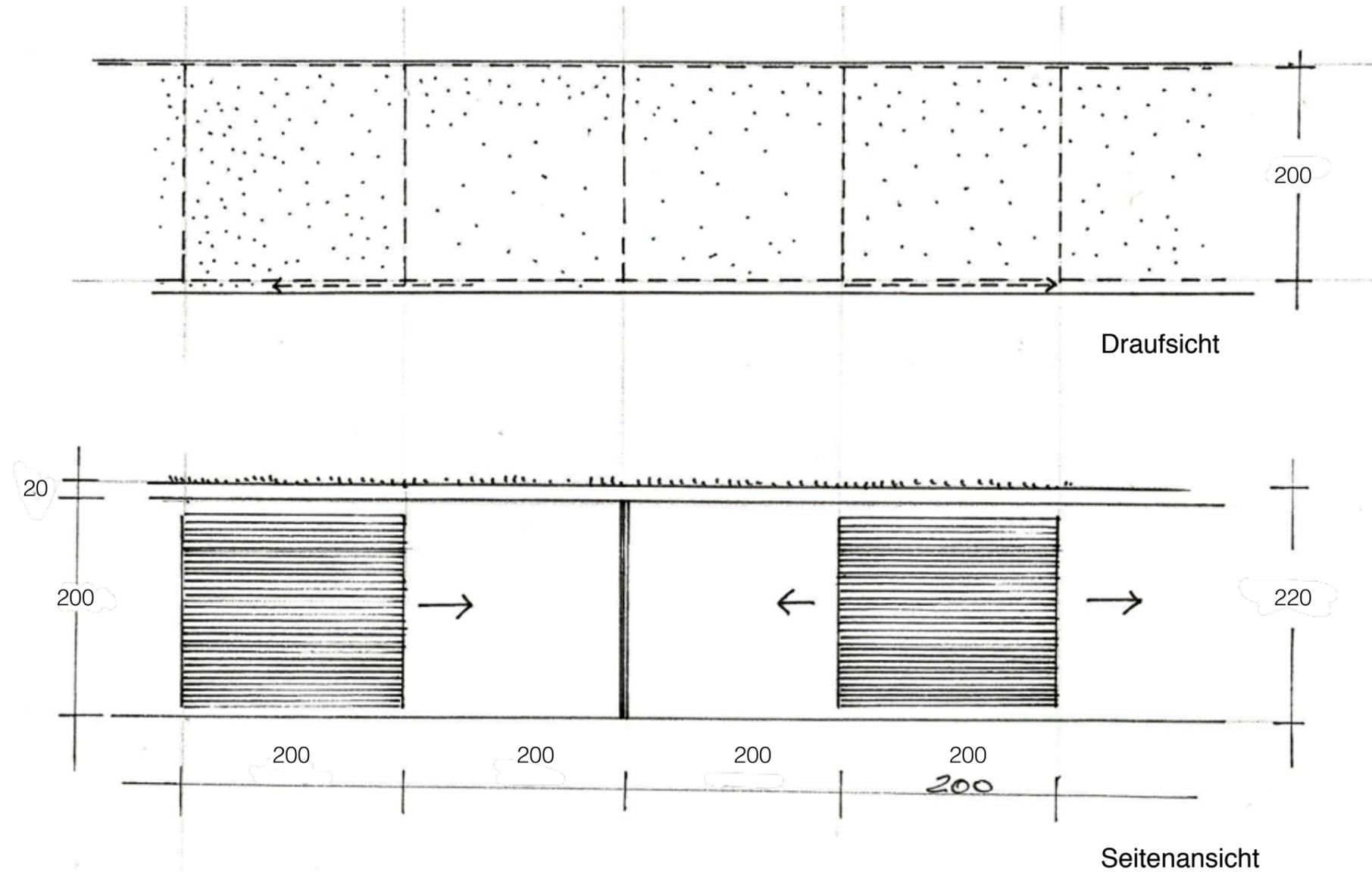
Seitenwände: teilweise geschlossen mit horizontalen Holzleisten, teilweise offen und teilweise mit Schiebewänden, Stahlkonstruktion mit Holzleisten; je nach Nutzungsart und Erfordernissen.
