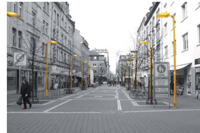
Referenzprojekt: Ersatz der Bestandsbeleuchtung (oben) gegen Lichtstelen mit LED-Technik (unten); Jede zweite Bestandsleuchte entfällt, Energieeinsparung 70% Herrstraße, Offenbach
