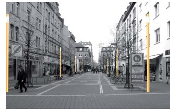
Referenzprojekt: Ersatz der Bestandsbeleuchtung (oben) gegen Lichtstelen mit LED-Technik (unten); Jede zweite Bestandsleuchte entfällt, Energieeinsparung 70% Herrstraße, Offenbach
