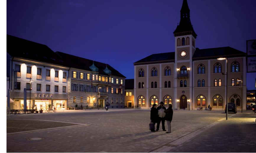
Referenzbeispiel Stadtplatz Pfaffenhofen: Illumination der raumbildenden Fassaden und geringe Grundausleuchtung der Platzfläche
