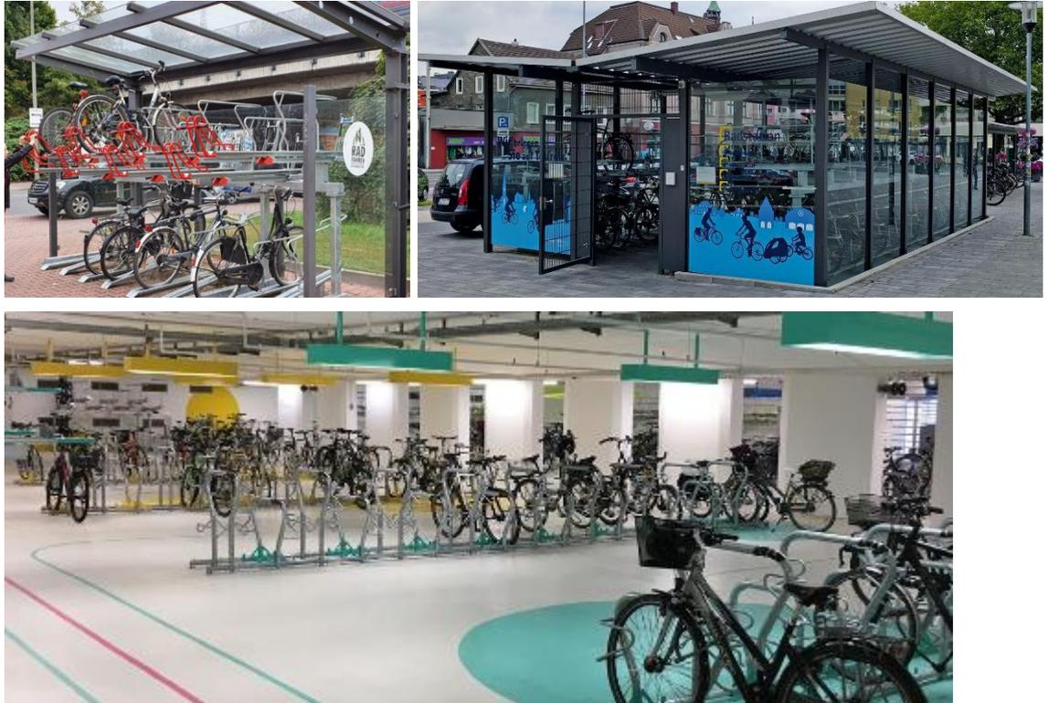
Abbildung 25 Beispiele von Organisationsformen: Doppelstöckige Anlage (oben links), Fahrradsammelanlage (oben rechts), Fahrradparkhaus (unten)
