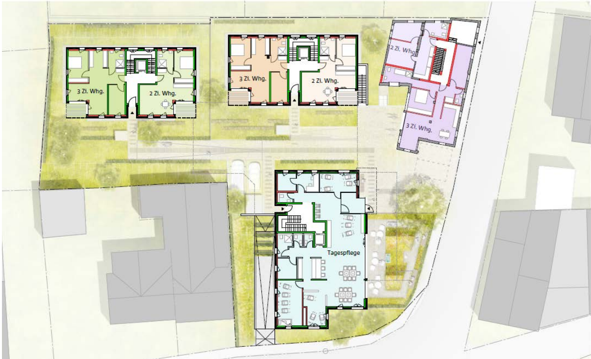
Abb. 14 Lageplan mit Grundrissen Erdgeschoss: Variante I mit vier oberirdischen Stellplätzen
