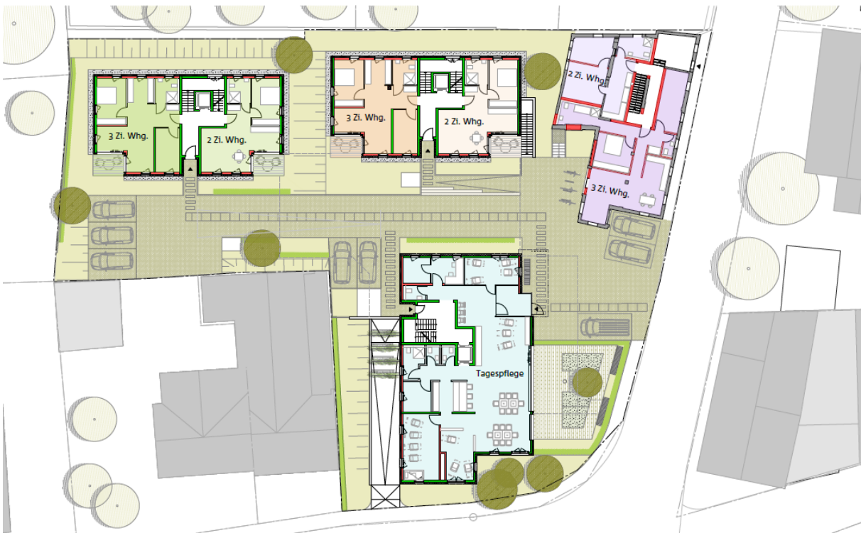
Abb. 15 Lageplan mit Grundrissen Erdgeschoss: Variante II mit acht oberirdischen Stellplätzen
