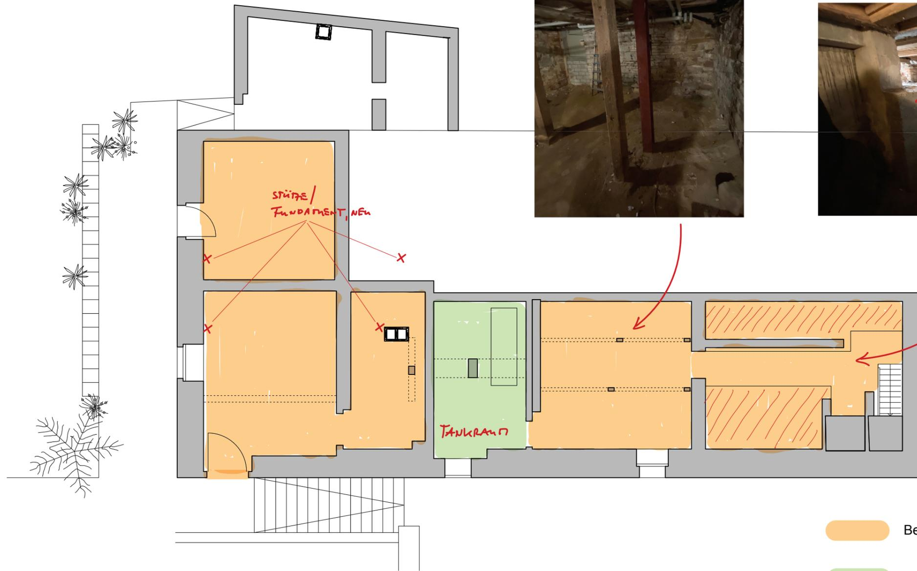
**Die gesamte UG-Decke muss durch eine neue Stahlbetondecke ersetzt werden!**
