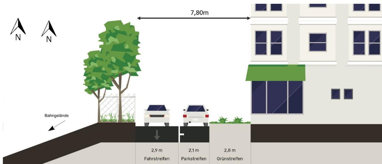
Abbildung 3 Querschnitt 2 Auflösung des Gehweges
