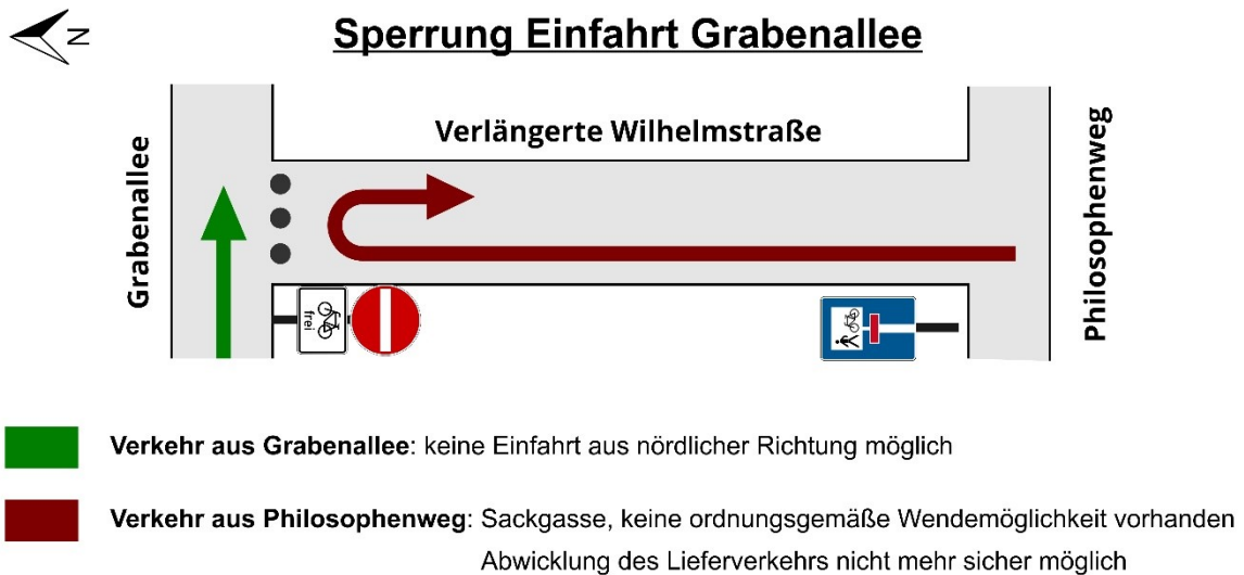
Abbildung 8 Variante mit gesperrter Einfahrt aus der Grabenallee
