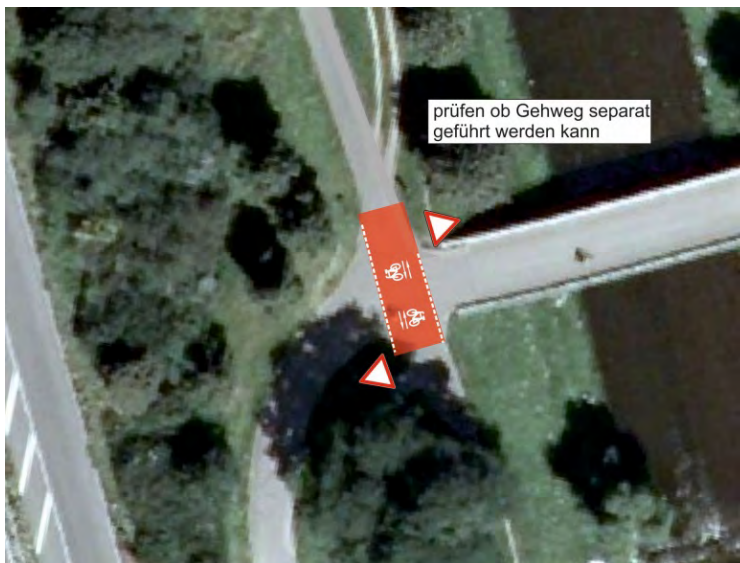
Abbildung 3-14: Einfärbung Querungsbereich Höhe Betzenhausener Brücke
