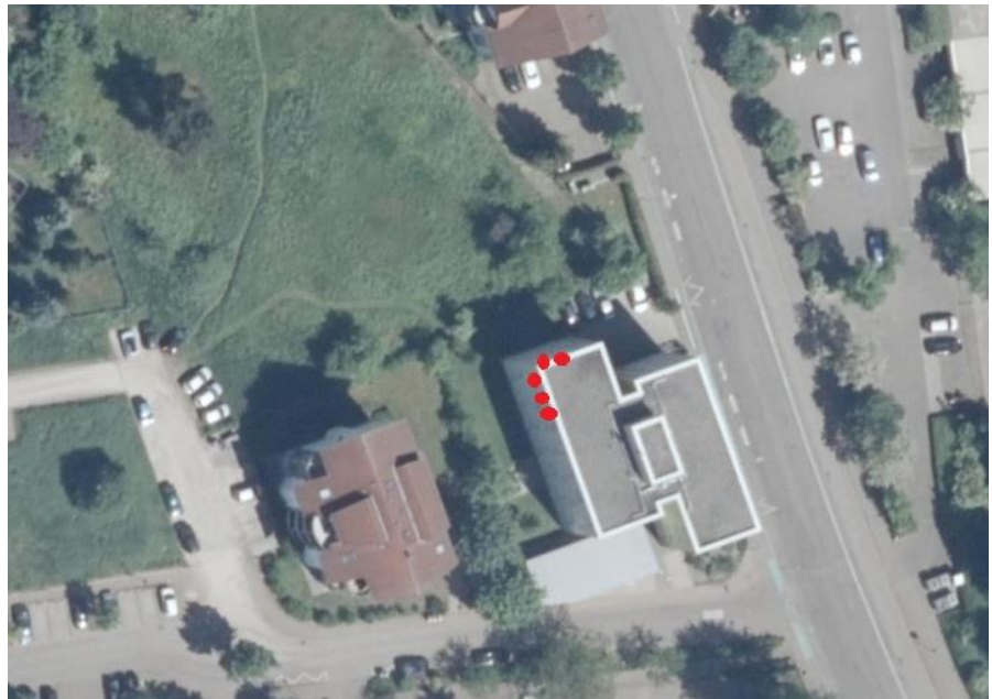
Abb. 4: Anbringung der Fledermauskästen (rote Punkte): Drei Kästen an dem Sims der Südwestfassade, zwei Kästen an der Nordwestfassade im Bereich der Gebäudeecke.
