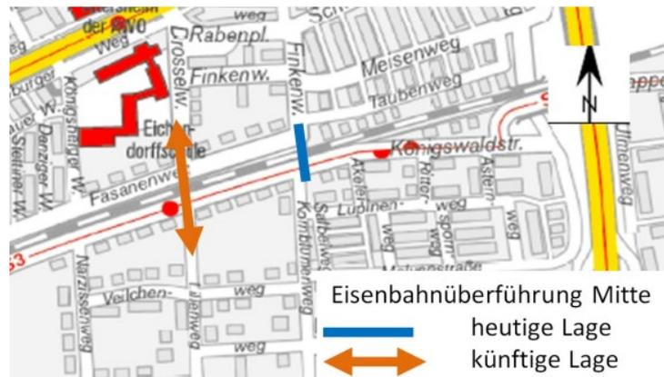
Die Unterführung ist künftig ausschließlich für zu Fuß Gehende und Radfahrende zugelassen. Sie wird barrierefrei mit je einer Rampe von ca. 70 m Länge (6 % Steigung mit Podesten) und einer lichten Breite von 5 m und einer Höhe von 2,50 m ausgeführt. Sowohl auf der Seite des Fasanenwegs als auch auf der Seite der Königswaldstraße ist je eine Treppenanlage vorgesehen, damit Umwege für zu Fuß gehende vermieden werden.
