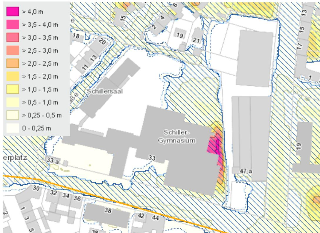
Abbildung 6: Überflutungstiefen im Fall eines HQextrem mit Legende,
