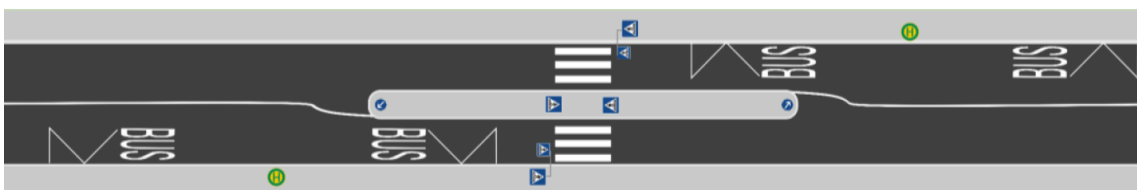
Abbildung 119: Skizze einer Haltestelle mit Querungshilfe für einen sicheren Fahrgastwechsel
