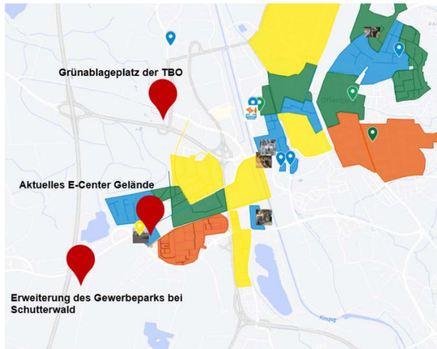
Abbildung 54: Geplanter Fernwärmeausbau des Wärmenetzes Offenburg (Blau: Bestand, Grün: geplanter Ausbau bis 2023, Gelb: geplanter Ausbau bis 2024, Orange: geplanter Ausbau bis 2026) mit eigenen Ergänzungen aus Wärmeversorgung Offenburg, 2021 (Wärmeversorgung Offenburg GmbH & Co. KG, 2021)
