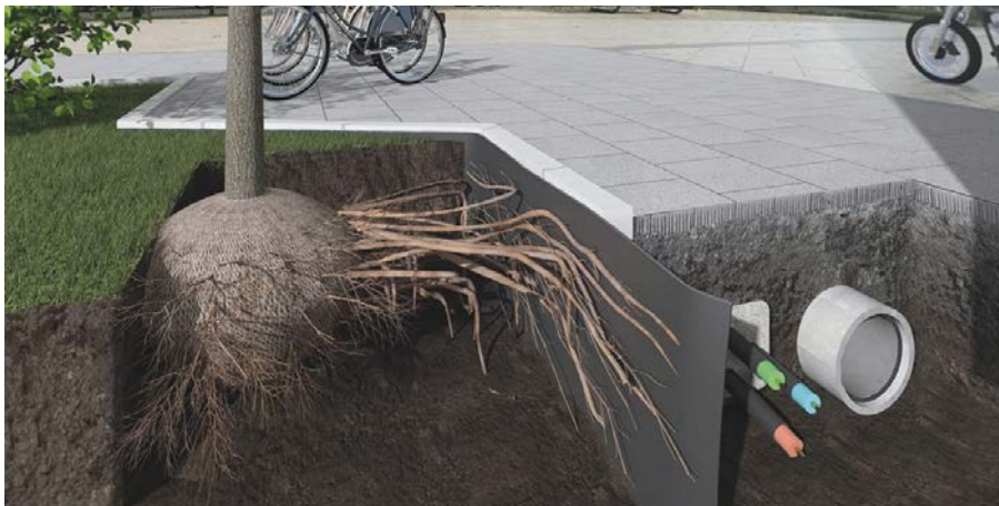
Abb. 11: Beispiel einer Wurzelschutzbahn zur Trennung von Wurzelraum und Leitungskorridoren
