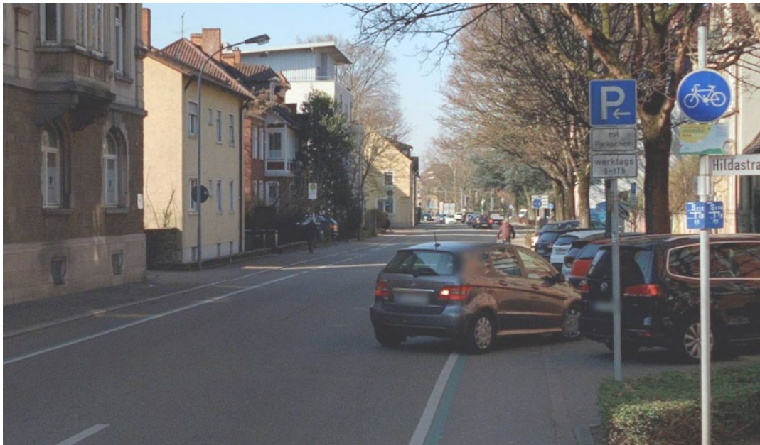
Abbildung 5: Radfahrstreifen vor Schrägparkplätzen in der Weingartenstraße
