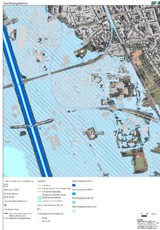
Darstellung Überflutungsflächen Südstadt im Fall HQ100 (dunkelblau) und HQExtrem (hellblau), Quelle LUBW Stand 04/2023
