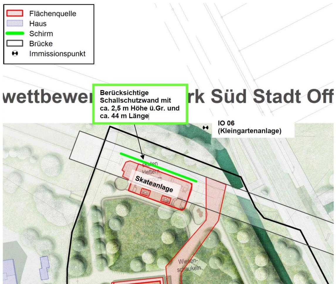
Abbildung 1: Lage und Maße der erforderlichen Lärmschutzwand zur Skateranlage (Lärmschutzgutachten).
